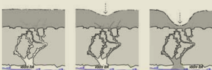
Proces nastajanja sufozijske vrtače z odnašanjem (sufozija, grezanje) nesprjete kamenine (pesek, glina) skozi razpoke v pod njo ležeče karbonatne kamenine oziroma, v primeru Udin boršta, razpoke apnenčevega konglomerata; Avtor: Tamara Korošec, priredil Mitja Prelovšek
